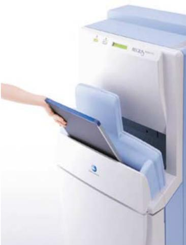
今回、フィルムレス運用に合わせ、CR（デジタルX線画像処理装置）も更新しました。CRではフィルムの代わりにイメージングプレートと呼ばれるエックス線を記録するプレートを使用します。これを読取装置で読取り、コンピュータで処理します。見たい部位に合わせた画像処理ができ、またデジタルなので保存が容易といった利点があります。
